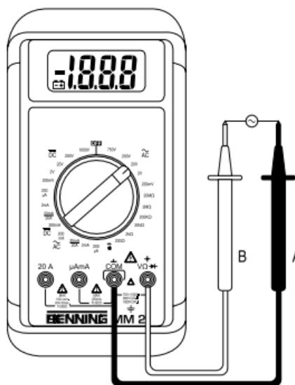
Bild 3: Wechselspannungsmessung
