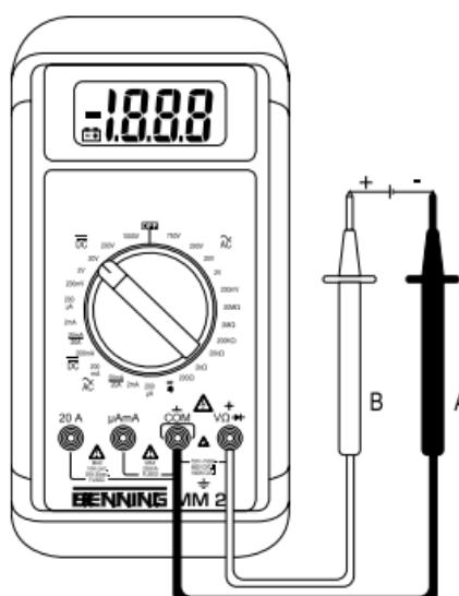
Bild 2: Gleichspannungsmessung
