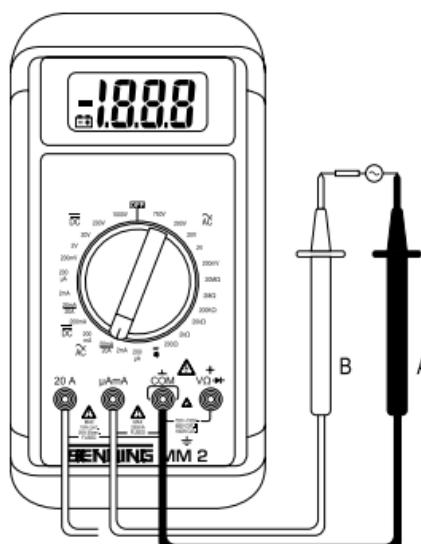
Bild 5: Wechselstrommessung
