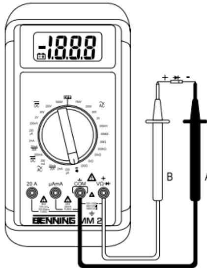
Bild 7: Diodenprüfung
